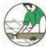
b) Raccorder les règles en enfonçant un acier à béton à l'intérieur de la chambre du sommet de la règle à joint.
