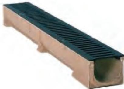
Caniveau à grille clipsée, largeur utile 100 mm, hauteur 115 mm, longueur 100 cm, classe de résistance B 125 selon norme EN 1433, titulaire du marquage CE et conforme à la norme d'accessibilité des personnes à mobilité réduite. Il se compose :
