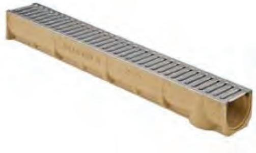
Caniveau à grille clipsée, largeur utile 100 mm, hauteur 115 mm, longueur 100 cm, classe de résistance B 125 selon norme EN 1433, titulaire du marquage CE et conforme à la norme d'accessibilité des personnes à mobilité réduite. Il se compose :
