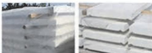
Le conditionnement sous film et les faisceaux de bois intercalés assurent la protection des produits lors du transport.
